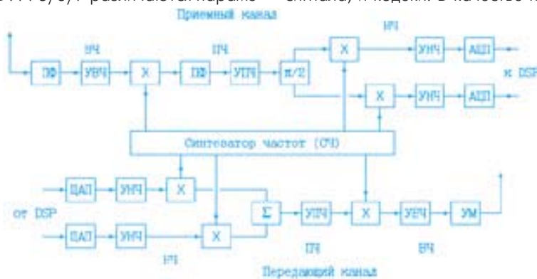
Рис. 1. Структурная схема приемопередатчика с преобразованием частоты
